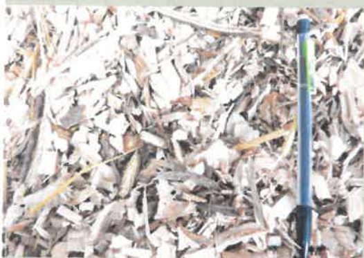
Plaquettes en séchage sous hangar pendant 4 mois minimum
