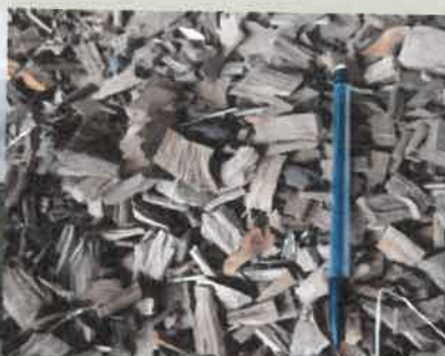
Plaquettes de bois d'Aulne, séchage pendant 4 mois sous hangar
