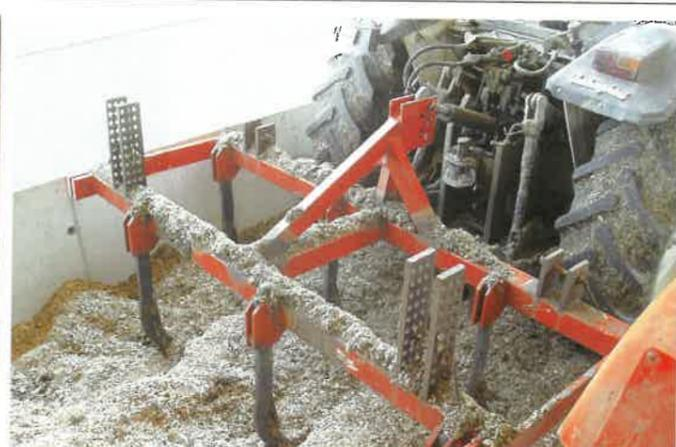
Das Umsetzen der Kompostmatte kann mit einer Fräse oder einem Grubber erfolgen.
