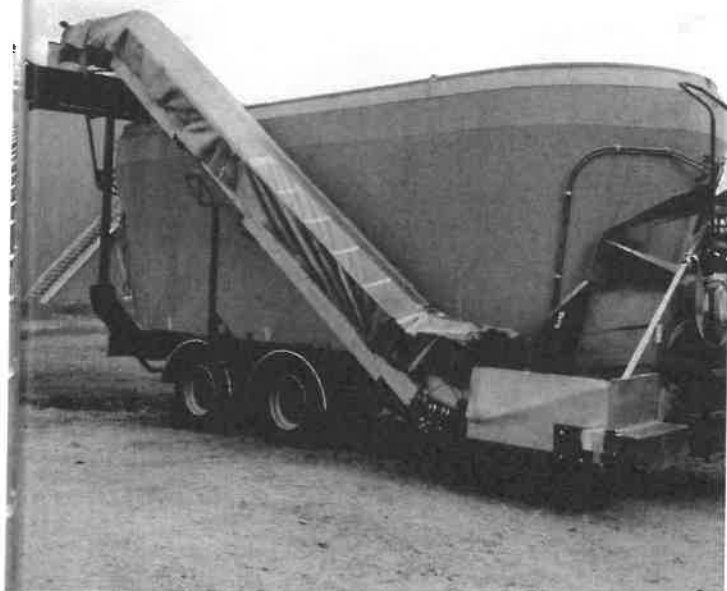
Mélangeuse adaptée pour alimenter les nourrisseurs à foin. Un convoyeur a été ajouté, pour les remplir par le haut.
