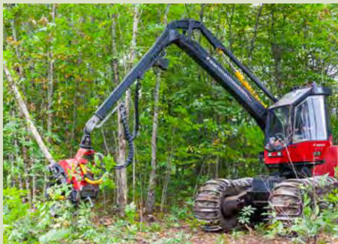
Exploitation mécanisée avec un combiné muni d'une tête d'abattage.
